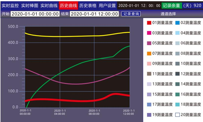
历史曲线与实时曲线基本相同，不同的时历史曲线与曲线间隔无关，直接输入开始时间与结束时间查询，无论是历史曲线还是实时曲线，坐标都是通过系统设置的坐标上限与坐标下限来实现的，注意曲线在显示开关量时，将接通状态的值显示为100，断开状态的值定义为0，主要是为了开曲线时更直观，方便产生感观更强的方波曲线图，通道有开关量输入时，在设置曲线坐标时，应当使坐标上限设置大于100以上。
