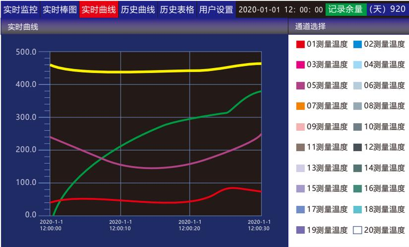
通道选择显示当前所有的可用的通道，如果当前通道被选中，以实心填充并显示当前通道的曲线，如果方框没有被填充，则不显示当前曲线。实时曲线从上电开始显示，能显示的曲线的点数取决于系统参数中的曲线间隔。整个曲线的时间长度 = 400X曲线间隔，曲线的点数为400个点，如果为1秒更新1次，那么整个曲线可显示400秒的数据。
