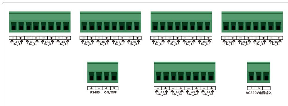
**控制输出：** D1-D16分别对应16个控制输出，可以为开关量输出，也可以为固态继电器输出，仪表在选型时决定输出类型。如果选配4-20mA输出，那么D1-D8可为模拟量输出，A1-A2公共报警输出，为开关量输出。
