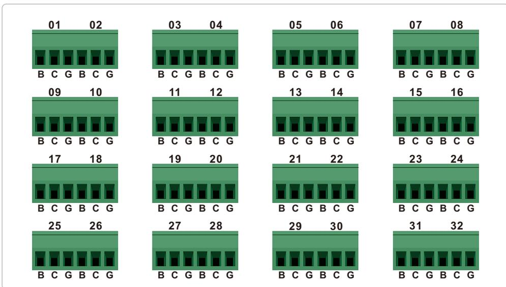
输入部份共有16组可插拔的端子，每组可接2路信号，最多可接入32路信号，每路信号有三个接线端口，分别为B、C、G。
